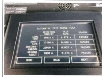
ทดสอบการทำงานของ Protective Relay Main ACB.
