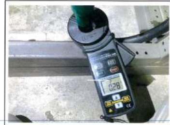
ตรวจวัดค่าความต้านทานดินภายในตู้สวิตช์บอร์ด
