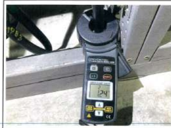
ตรวจวัดค่าความต้านทานดินภายในตู้สวิตช์บอร์ด
