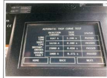
ทดสอบการทำงานของ Protective Relay Main ACB.
